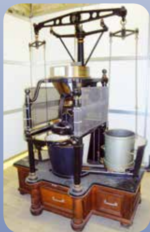
Figure 23 : Instrument de référence du Laboratoire d'Encadrement Référentiel permettant de déterminer la masse à l'hectolitre des céréales sur base d'un contenant de 20 litres. (Source : Laboratoire d'Encadrement Référentiel).
