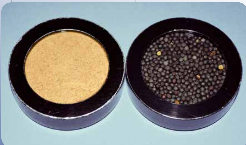
Figure 5 : Cellules de mesure utilisées en spectrométrie infrarouge. La cellule de gauche contient l'échantillon de colza et celle de droite l'échantillon de tourteau de soja broyé. (Source : Laboratoire d'Encadrement Référentiel).
