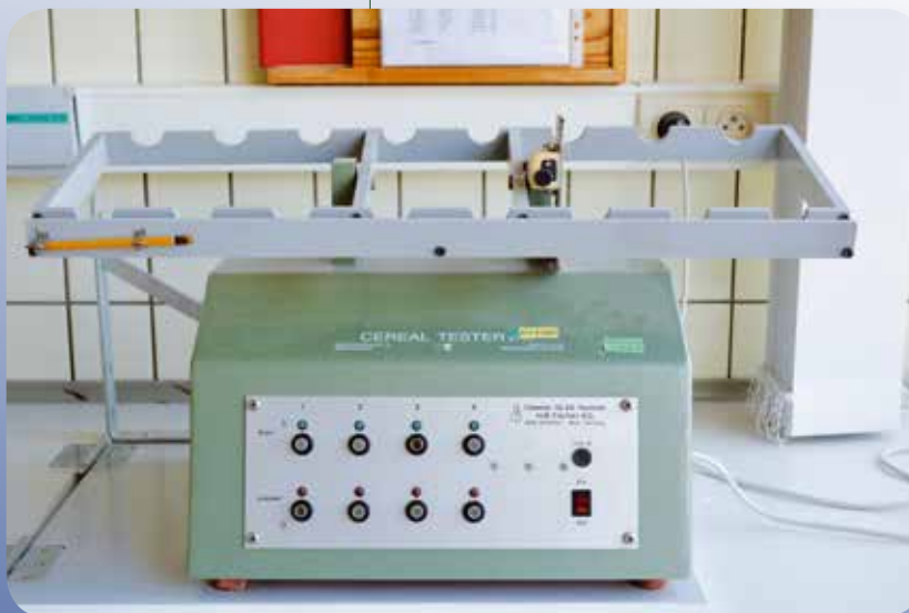
Figure 24 : Appareil de type Brabender utilisé pour la détermination du Zélény. (Source : Laboratoire d'Encadrement Référentiel).
