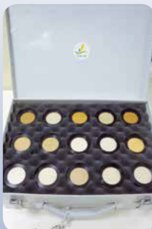
Figure 14 : Boîte de standardisation contenant des échantillons standards utilisés par le Laboratoire d'Encadrement Référentiel pour rendre similaire la réponse spectrale des spectromètres du réseau REQUASUD.
