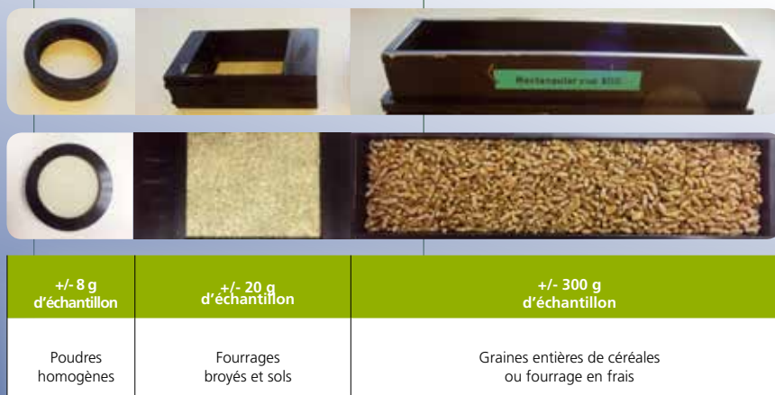
Figure 11 : Les cellules de mesure utilisées par le réseau REQUASUD pour les mesures PIR. (Source : Laboratoire d'Encadrement Référentiel).
