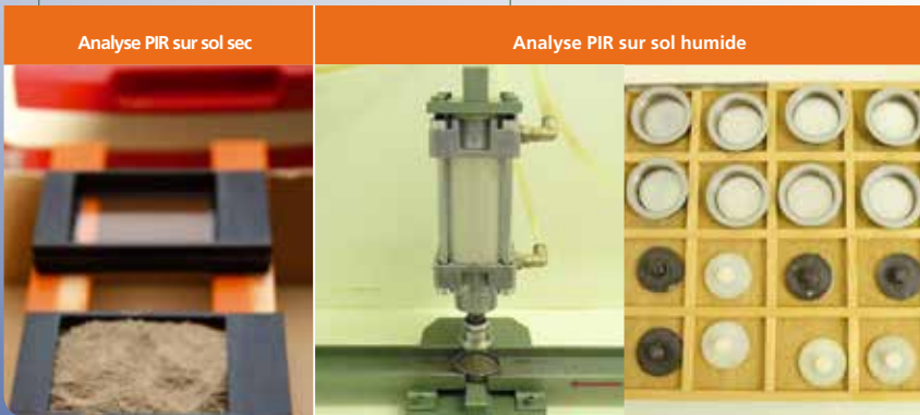
Figure 27 : Dispositifs permettant de préparer les coupelles de terre en vue de saisir leur spectre PIR. (Source : Laboratoire d'Encadrement Référentiel).
