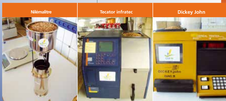
Figure 22 : Différents types d'instruments permettant de mesurer la masse à l'hectolitre. (Source : Laboratoire d'Encadrement Référentiel).
