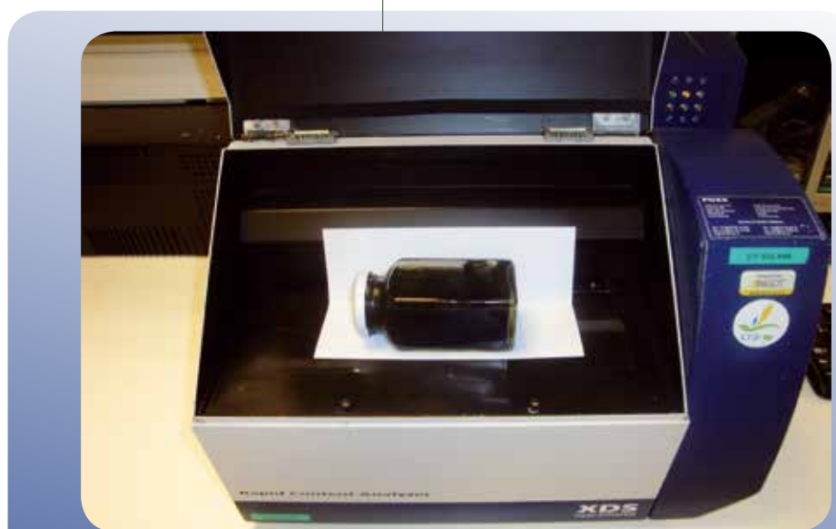
Figure 30 : Mesure infrarouge d'un bocal contenant du lisier. (Source : Laboratoire d'Encadrement Référentiel).
