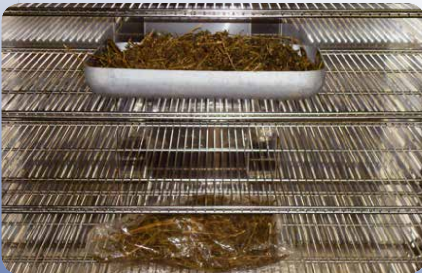
Figure 10 : Etuve destinée au séchage des fourrages et ensilages. L'opérateur veillera de disposer les échantillons en fine couche et de les retourner toutes les demi-journées afin d'obtenir un séchage homogène. (Source : Laboratoire d'Encadrement Référentiel).
