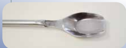
Figure 12 : Spatule à bord droit recommandée pour le remplissage des coupelles de mesure. (Source : Laboratoire d'Encadrement Référentiel).
