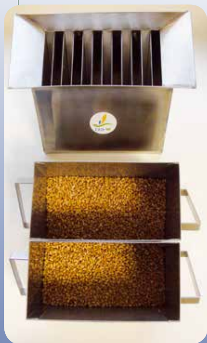
Figure 13 : Répartiteur à rifles utilisé pour partitionner de manière homogène les échantillons. (Source : Laboratoire d'Encadrement Référentiel).
