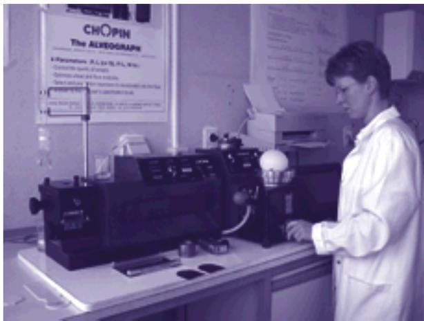
L'essai à l'alvéographe évalue les caractéristiques rhéologiques d'une pâte à hydratation constante (force boulangère, extensibilité, ténacité et élasticité) et permet de prédire l'aptitude d'une farine à la fabrication de produit de cuisson (pains, biscuits, gâteaux, ...).
