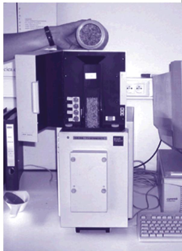
L'étalonnage consiste à développer un modèle mathématique reliant les données spectrales aux valeurs obtenues par les méthodes de référence, d'une population d'échantillons représentatifs du produit à analyser. Un modèle doit être établi pour chaque produit et chaque constituant. Une fois ce modèle établi, il est utilisé en routine sur base des données optiques uniquement, pour analyser rapidement de grandes séries d'échantillons, et pour une détermination simultanée de plusieurs paramètres.
